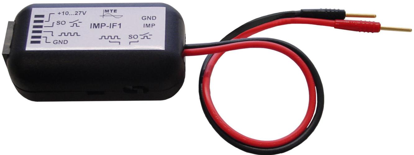
Das Impuls-Interface IMP-IF1 dient zur Prüfung von Sendekontakten, Transistorenausgängen und echten S0-Schnittstellen und kann sowohl mit verschiedenen Apparaten als auch auf Zählerprüfeinrichtung eingesetzt werden.
